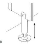
**PATA**. Se ajusta a la altura de la cabina, asegúrese que la altura deseada se encuentra dentro del intervalo que permite el pie.
