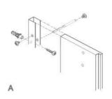
**FIJACION A PARED**. Utilicemos la U de pared para sujetar el panel a pared. Hay que colocarla coincidiendo con los taladros del panel.
